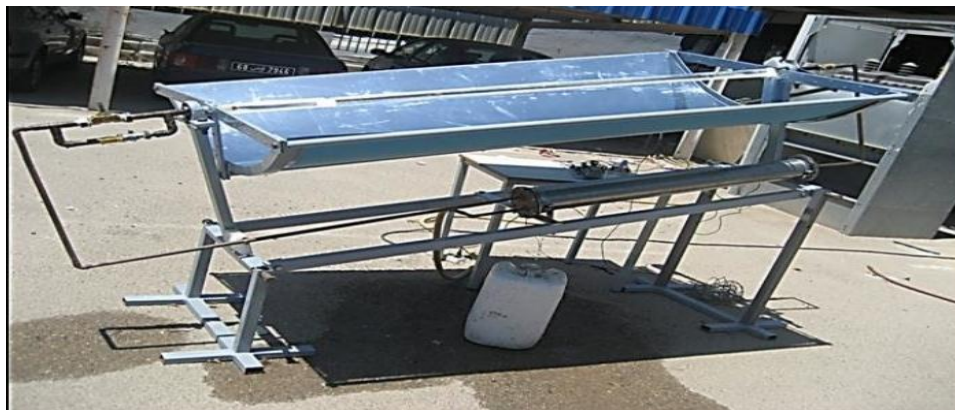
Figure 3.6. Montage du concentrateur cylindro-parabolique [9]
