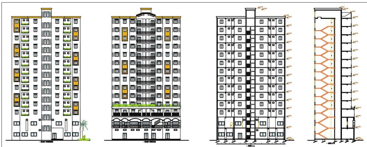
Figure 2.1c : Vues en plan (façade principale ; façade postérieure ; Coupe A-A et coupe B-B)
