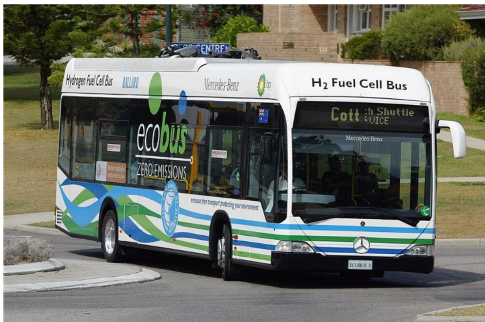
Figure I.2. L'EcoBus3 à hydrogène de Mercedes-Benz est animé par un moteur électrique alimenté par une pile à combustible [15]
