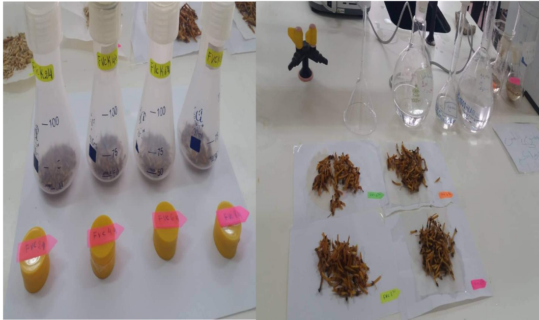
Figure.III.6. Traitement chimique par NaOH sur les fibres végétales de cynodon
