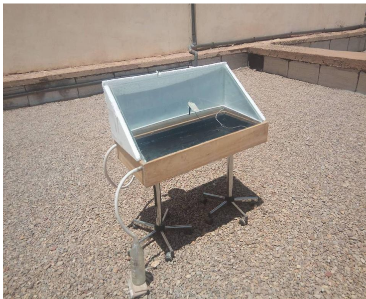
Figure III. 2 .Photo de l'installation expérimentale de distillateur conventionnel.
