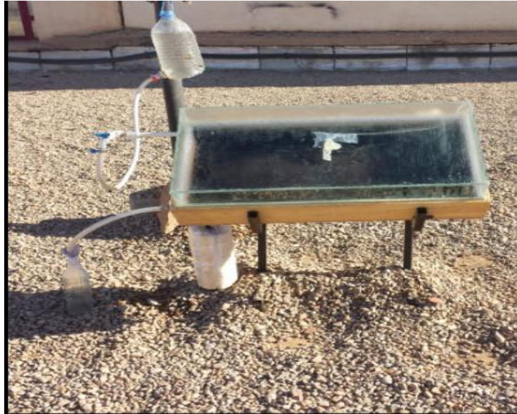
Figure III. 1. Photo de l'installation expérimentale de distillateur à mèche
