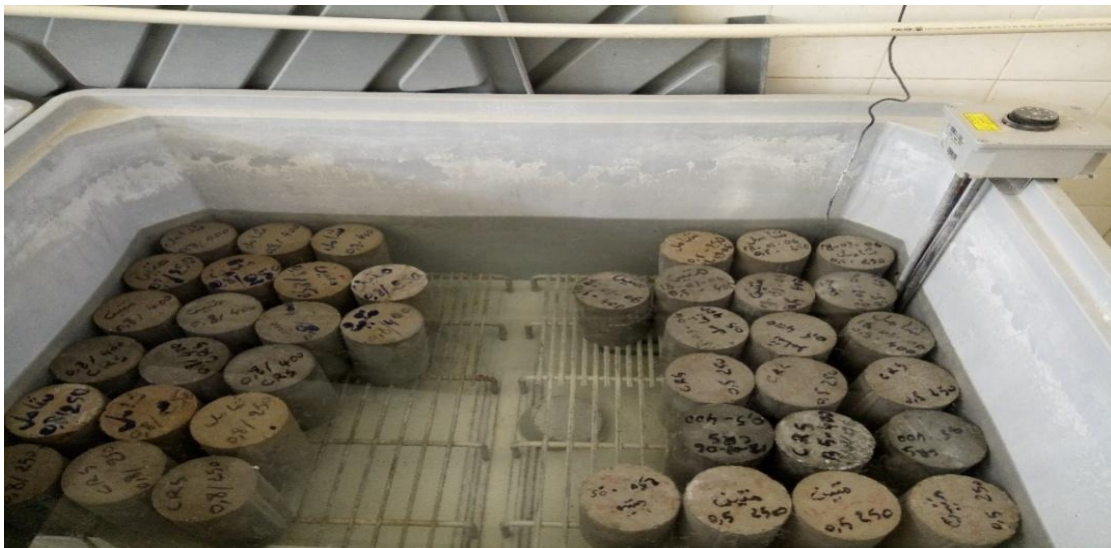
Figure IV. 5: Même cure plongées dans l'eau à 20 °C pendant 28 jours
