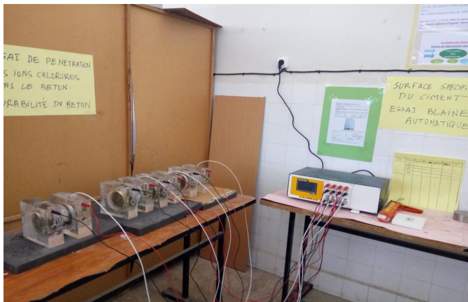
Figure IV-8 : Appareil de mesure de pénétration des ions de chlorures dans le béton
