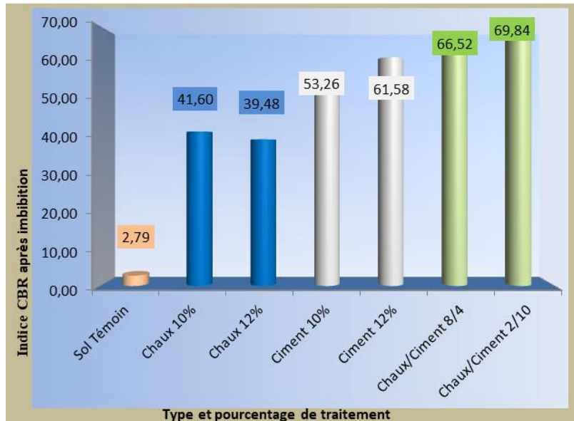
Figure III-8 : Histogramme de comparaison de l'indice de CBR après imbibition
