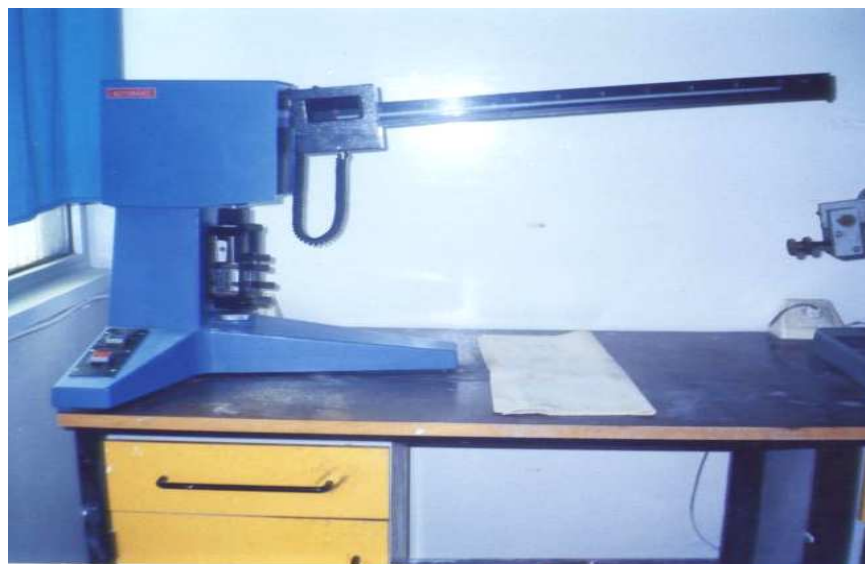
Fig. (III.2) : Appareil de flexion (cimenterie de Ain Touta).
