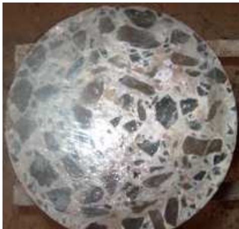
Attaque du béton de par la solution De sulfate d'alumine, 9 mois d'immersion, (cure de 7jour) d'immersion.
