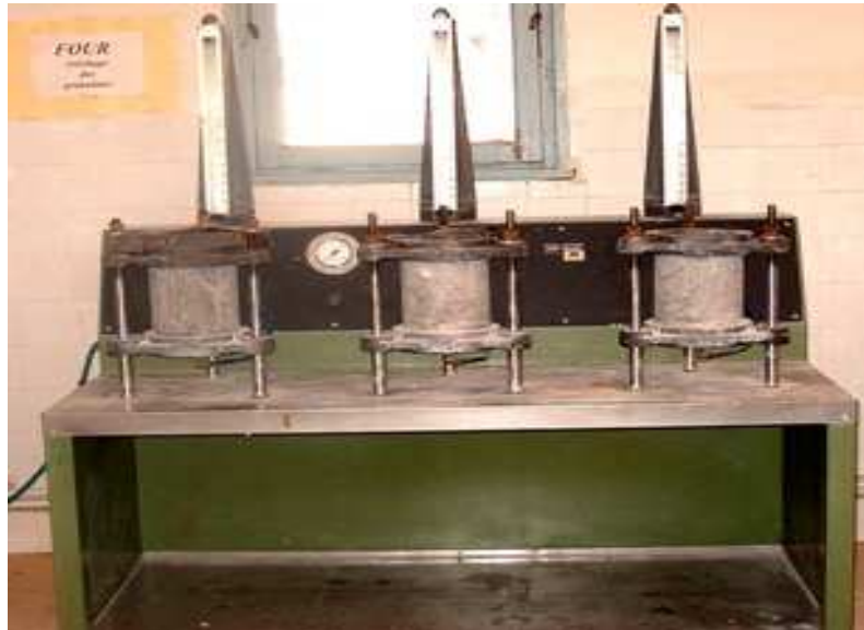
Fig.(III.6) :Perméamètre à l'eau(laboratoire de (Géomatériaux-M'sila).
