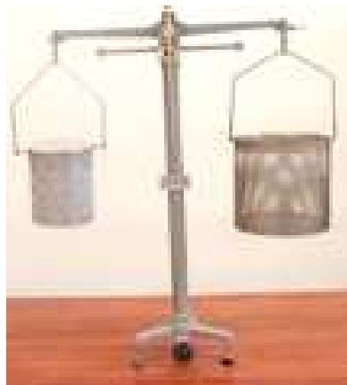
Fig.(III -4) Pesée hydrostatique des éprouvettes pour calcul de la porosité.
