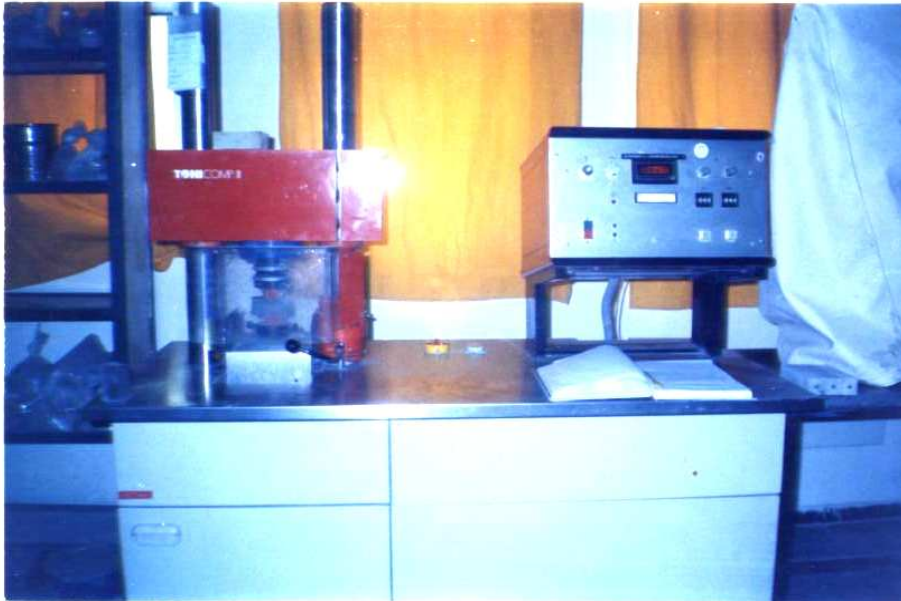
Fig.( III.1) :Appareil de compression pour mortier(cimenterie de Ain Touta).
