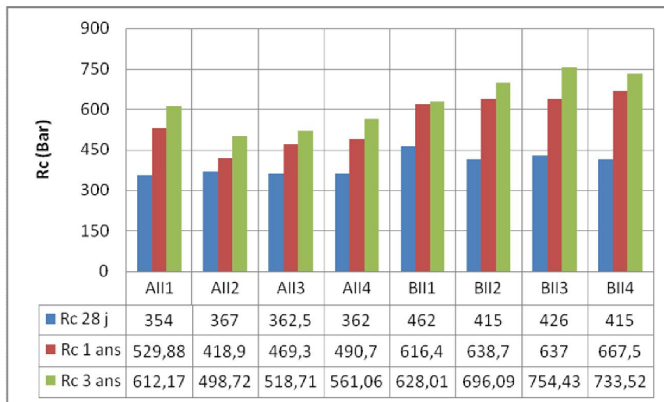
Figure IV-16 Résistances mécaniques à la compression a long terme des ciments types AII et BII (17,50% Pouzzolane ou Laitier + 17,50% calcaire) en fonction de la surface spécifique des ajouts
