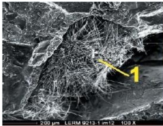
Figure I-3 photo au MEB d'une ettringite étendue dans un pore (Marchand et al., 2003)
