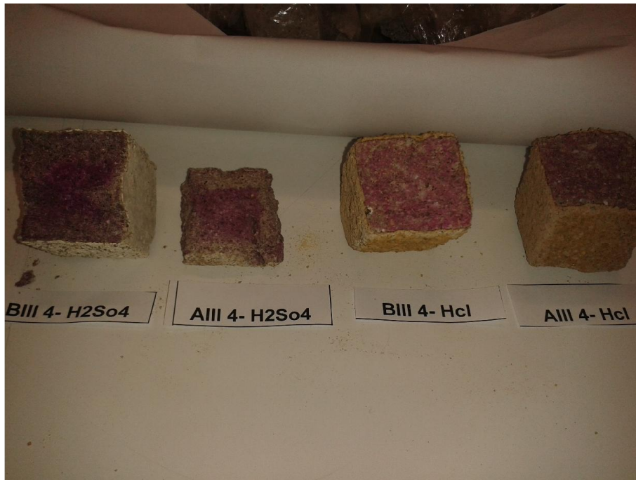
Figure V-17 Profondeurs de l'alcalinité réduite des mortiers types A et B (H 2 SO 4 /HCl)
