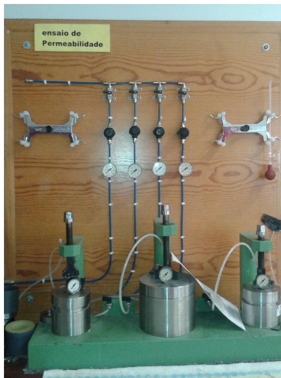
Figure III-17 Photos Dispositif de mesure de la perméabilité ( laboratoire C-MADE) UBI
