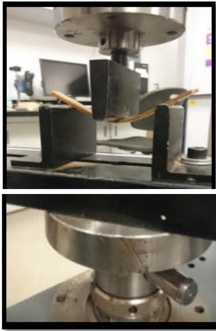
Figure III-2: Dispositif de mesure utilisé pour le test de flexion
