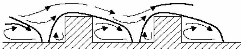
Fig.4-1 : Comportement de l'écoulement entre deux obstacles, régime d'interférence de sillage [d'après Shahram Tehranian et Al. 2001]
