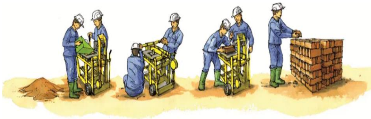
Fig III. 8. Les étapes de fabrications du BTC
