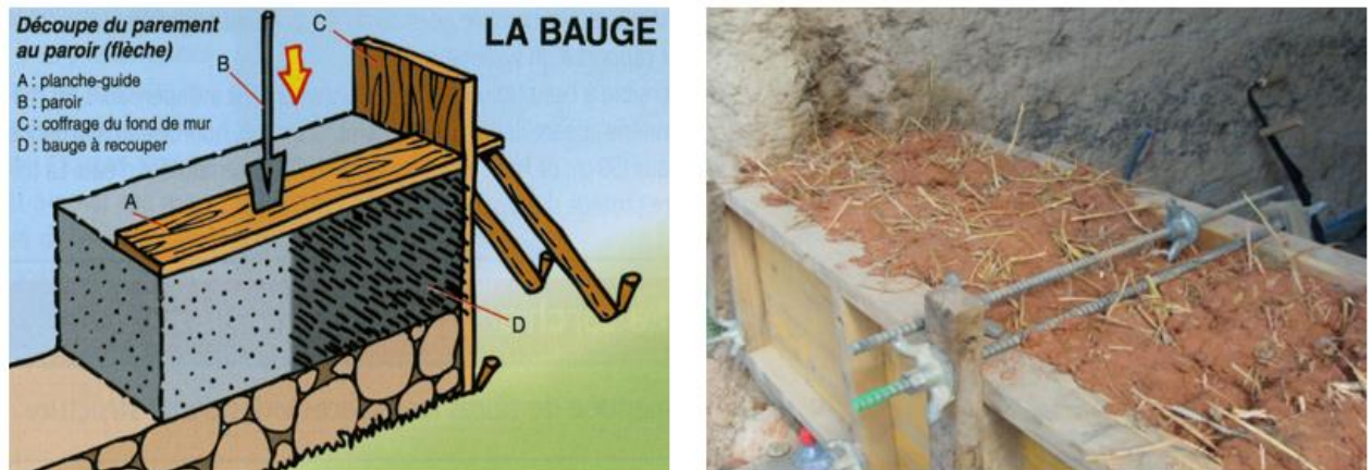
Fig III. 7. Technique de fabrication du Bauge
