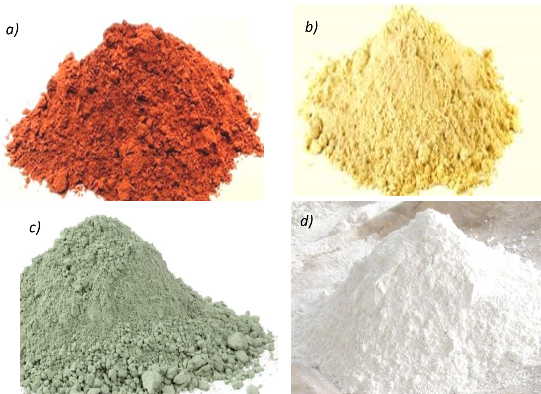
Fig III. 3. Classification des argiles selon la couleur [21]
