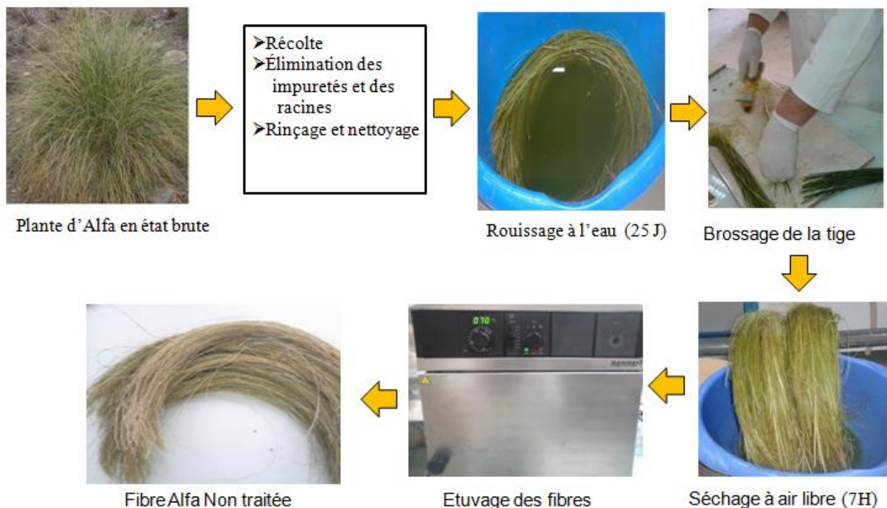
Fig IV. 4. Techniques d'extraction des fibres Alfa
