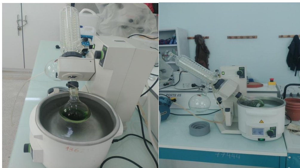
Figure 07: Rotavapeur de type BÜCHI-R-120 (Oufiada, R et Zekraoui,A ,2019)
