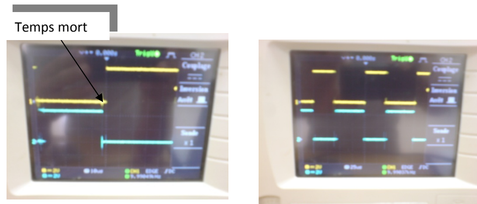
Figure V.17 les deux signaux PWM complémentaires de commande
