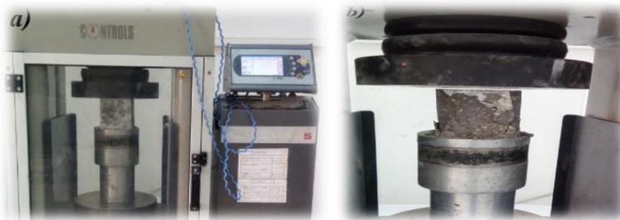
Figure IV.4 : Essai compression : a) machine et éprouvette, b) éprouvette détruite.
