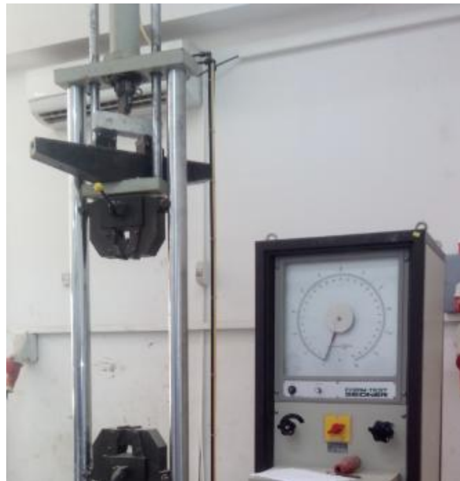
Figure II.2 : Dispositif pour mesurer la résistance à la traction par flexion.
