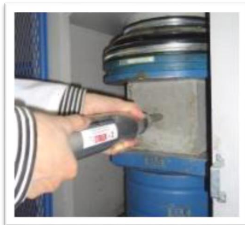
Figure IV.6 :Principe de l'essai scléromètre.
