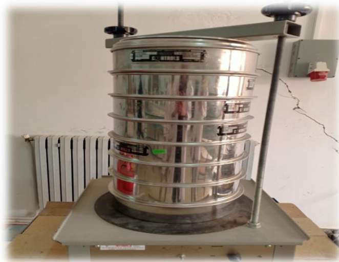
Figure III.1: Appareil de l'analyse granulométrique
