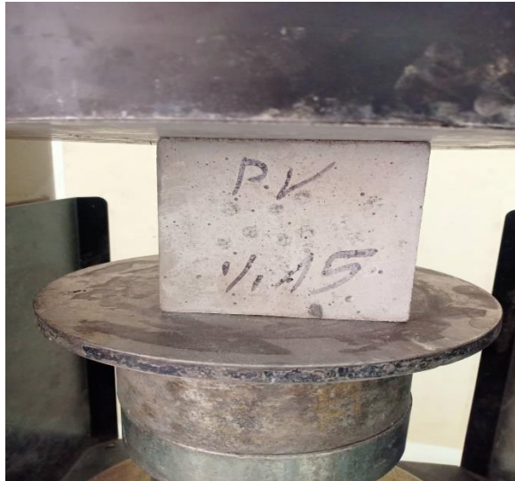
Figure II.1 : Dispositif pour mesurer la résistance à la compression .
