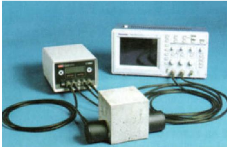
Fig II.7 : Appareil d'auscultation sonore.
