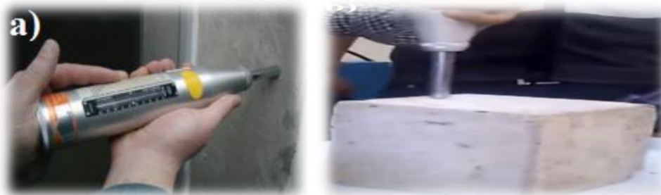
Figure II.6 : a) Mesure sur surface béton, b) sur éprouvette cubique (10*10*10) cm 3 [3].
