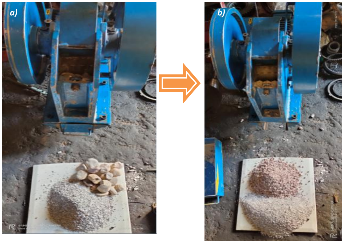
Fig . IV.9 Examen du fonctionnement du broyeur pour de grande dimensions a) avant broyage b) après broyage
