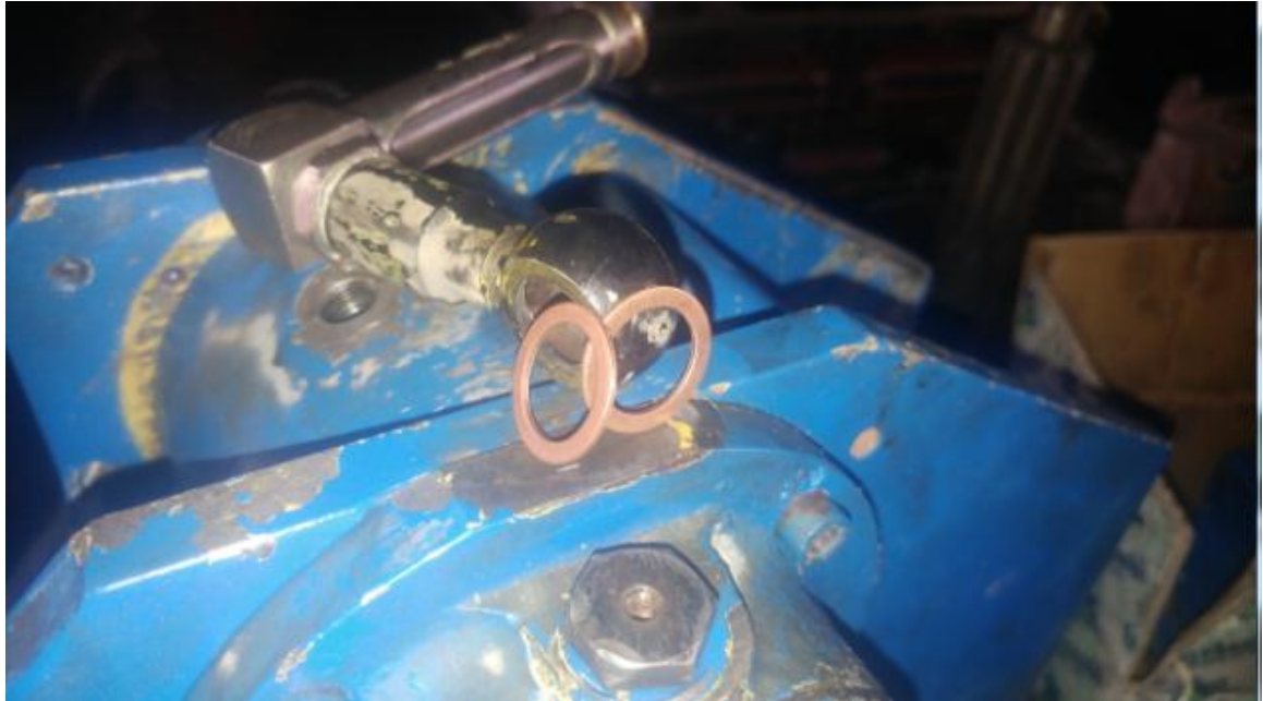
Fig . IV . 6 changement des joints et de rondelles d'huile
