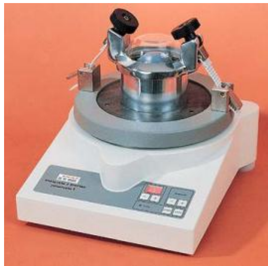
Fig. II.5. Schéma du broyeur planétaire de type pulvérisette (P0)
