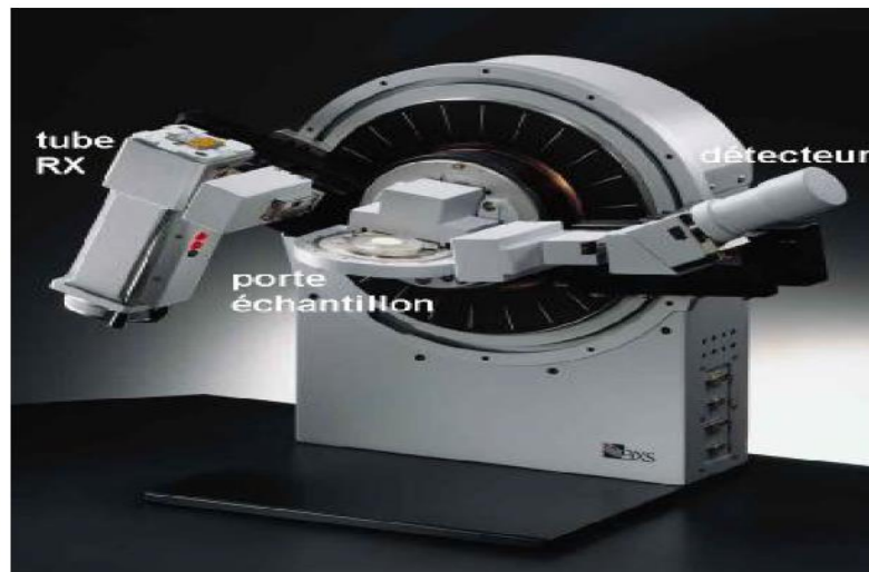
FigureII.7 : Goniomètre de la marque Bruker-AXS, type D8 [2].
