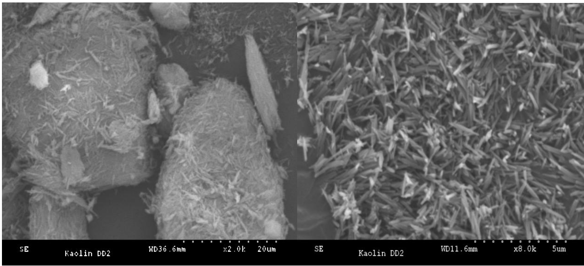
الشكل II.1: صورتان بالمجهر الإلكتروني الماسح لحبيبات مادة الكاولان الخام DD2.
