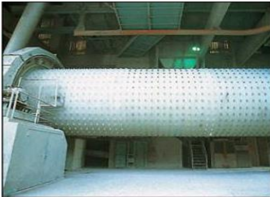
Figure I- 2: Broyeur sécheur à boulets.
