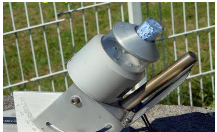
Figure (I.17): Héliographe à fibres optique
