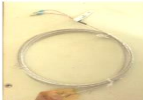
Figure II.16: Capteur de température de type sonde PT100
