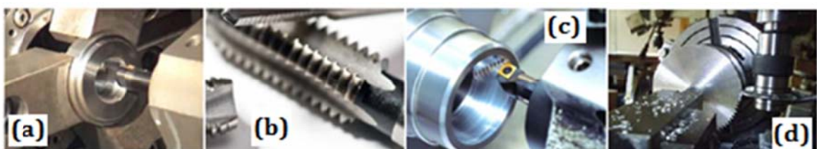
Figure II.5. (a) le mortaisage, (b) le brochage, le taraudage, (c) l'alésage, (d) taillage d'engrenage. [4,5]
