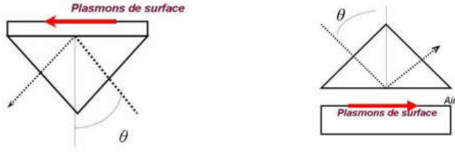
Figure I.5 : représentation des deux méthodes dites ATR (Attenuated Total Reflexion): à gauche, configuration de Kretschmann-Raether, à droite, configuration d'Otto.
