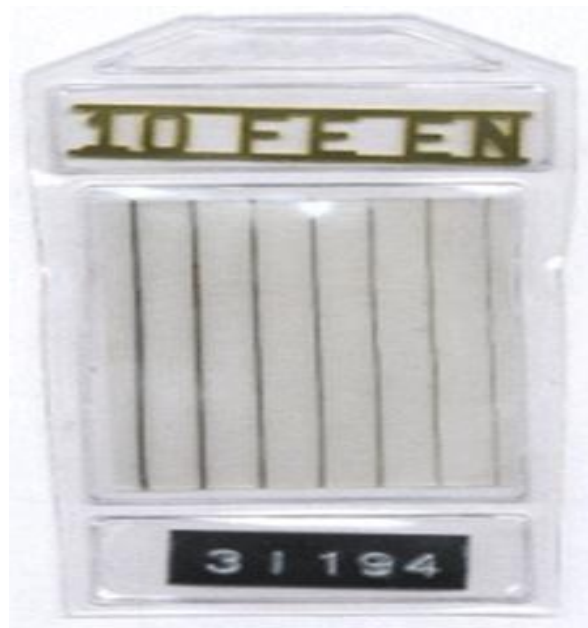
Figure IV.17: Indicateur qualité image a fils
