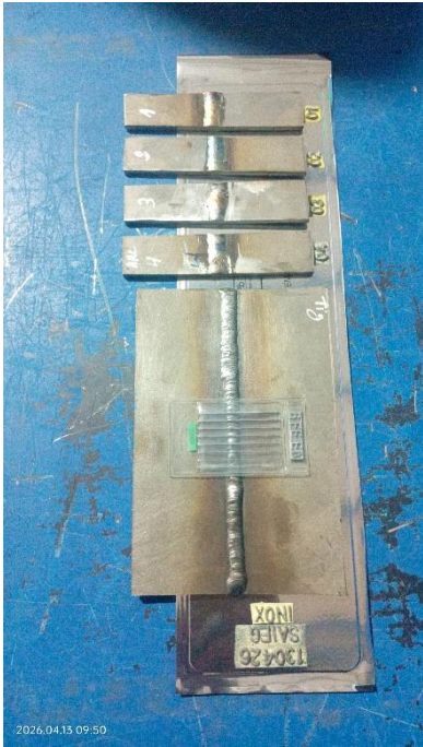
Figure 12 pose du film radiographique et IQ
