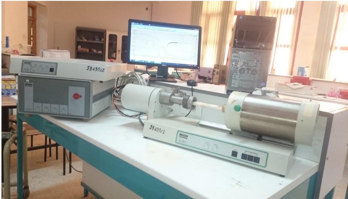
الشكل (6.III): جهاز التمدد الطولي التفاضلي.
