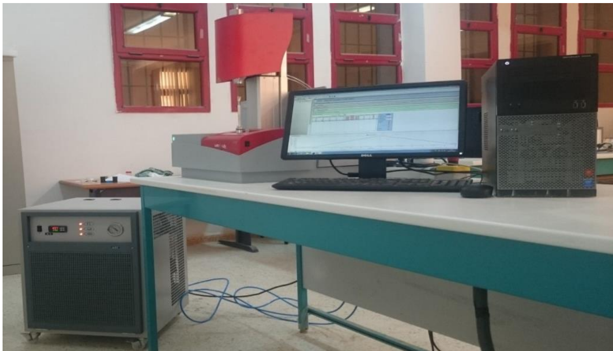
الشكل (7.III): جهاز التحليل الحراري الكتلي و التفاضلي من نوع (labsyveo).
