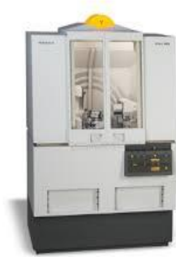
الشكل (5.III): جهاز حيود الاشعة السينية من نوع Panalytical
