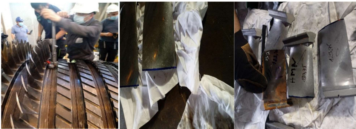
Figure IV-9 Dégradation des aubes mobiles.
