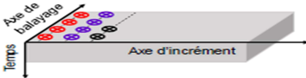
Figure IV-12 Schéma définissant les axes repères pour un contrôle ultrasonore. [34]
