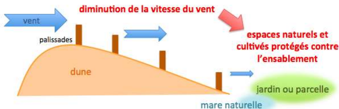
Figure N° 37 : Schéma de fonctionnement La fixation mécanique des dunes
