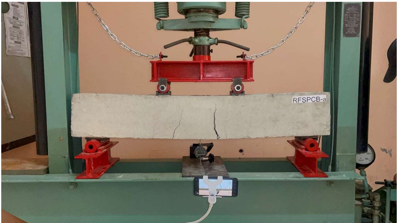
Figure 3. 12. Essai de flexion de la poutre armées et renforcées de fibres.
