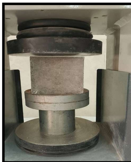
Figure 3. 1.Essai de compression uniaxiale sur éprouvettes de béton
