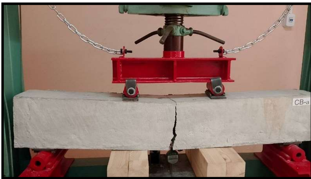
Figure 3. 7. Essai de flexion de la poutre fibrées sans ferrailage.
