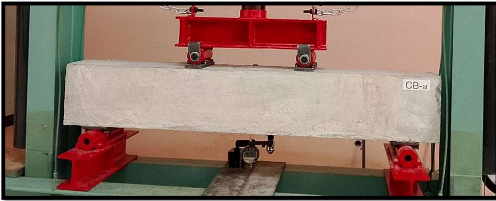
Figure 3. 7. Essai de flexion de la poutre fibrées sans ferrailage.
