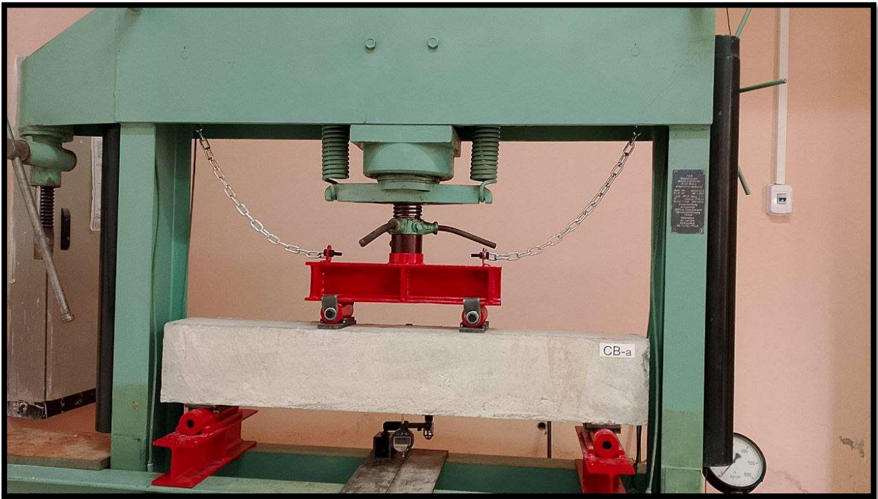
Figure 3. 6 Machine d'essai de flexion en quatre points
