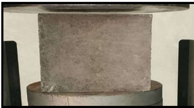
Figure 3. 2 – Éprouvettes normalisées pour essais de compression
