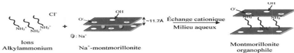
Figure I.9 : Représentatif du processus d'échange cationique entre les cation alcalins ( Na^+ ) et les ions alkylammonium
