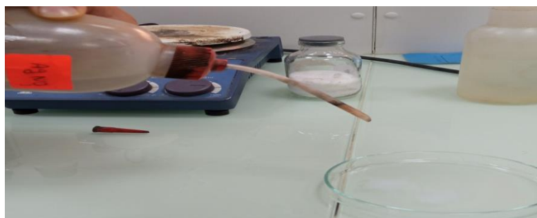
Figure II.4 : La vérification de l'absence du chlore se fait par ajout d'une goutte d' \text{AgNO}_3 à chaque eau de lavage .
