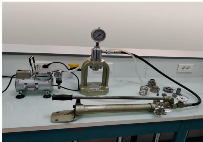
Figure II.7 : Presse pour préparation de pastille KBr.
