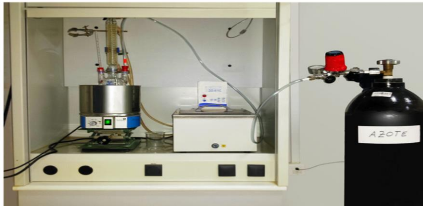
Figure II.5: Montage de la manipulation de greffage du TESPSH sur la Mt-TMTDA.
