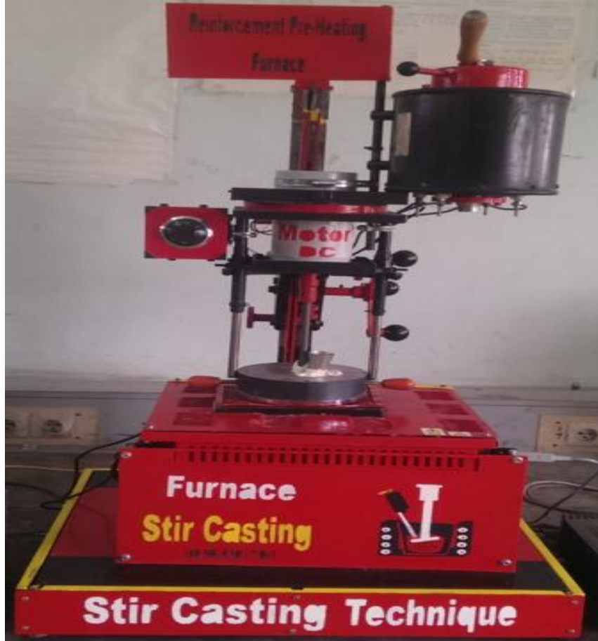
الشكل (1.II): الجهاز التجريبي المستعمل في تحضير العينات.
