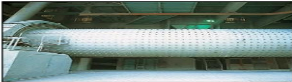
Figure I.1: Broyeur sécheur à boulets
