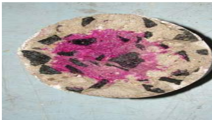
Figure II.9: Détermination de la profondeur de carbonatation [69].
