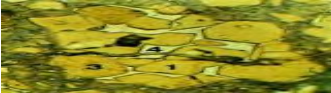
Figure I.3: grains polycristallins d'un ciment anhydre (image obtenue par microscopie optique en lumière réfléchie sur section polie légèrement attaquée par HNO):1=C 3 S; 3=C 2 S; 4=C 3 A+C 4 AF.
