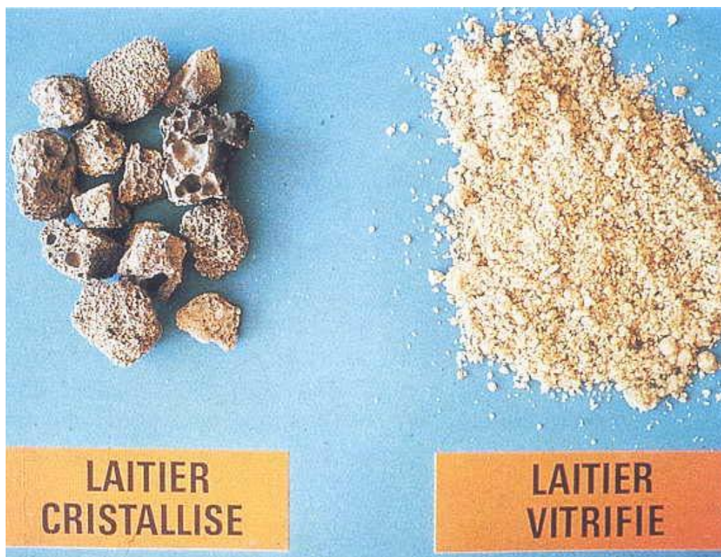
Figure I.8. Laitier cristallisé et laitier vitrifié (granulé) de haut fourneau
