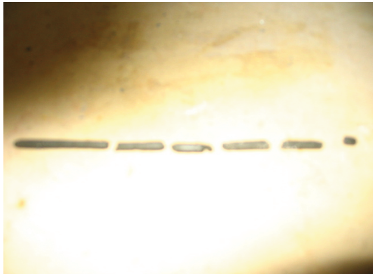
PHOTO 2 : Détermination de la limite de plasticité (bâtonnet de sol)
