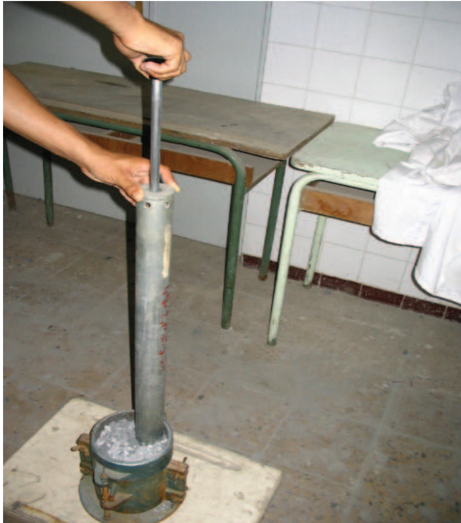
PHOTO 5 : Compactage du matériau dans le moule CBR
