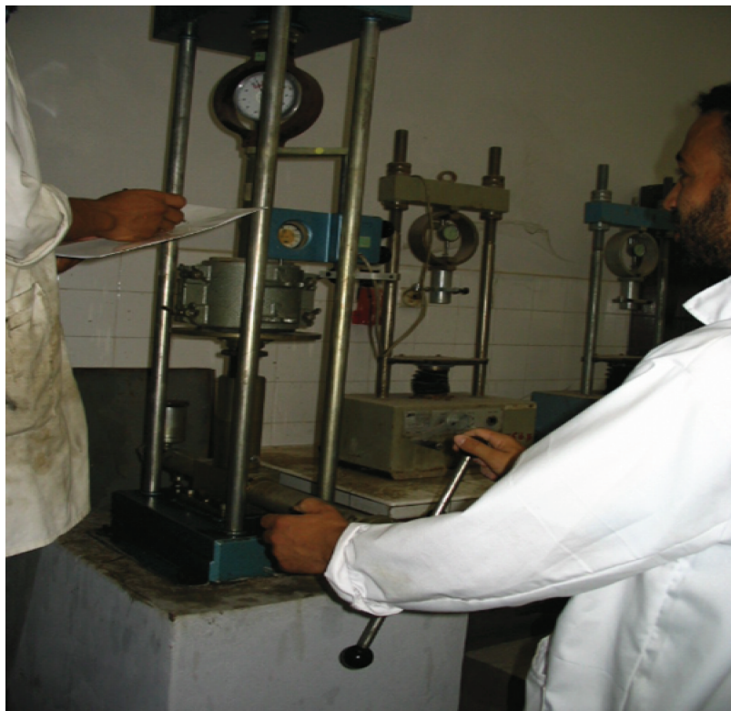
PHOTO 7 : Dispositif utilisé pour le poinçonnement des éprouvettes (Presse hydraulique)
