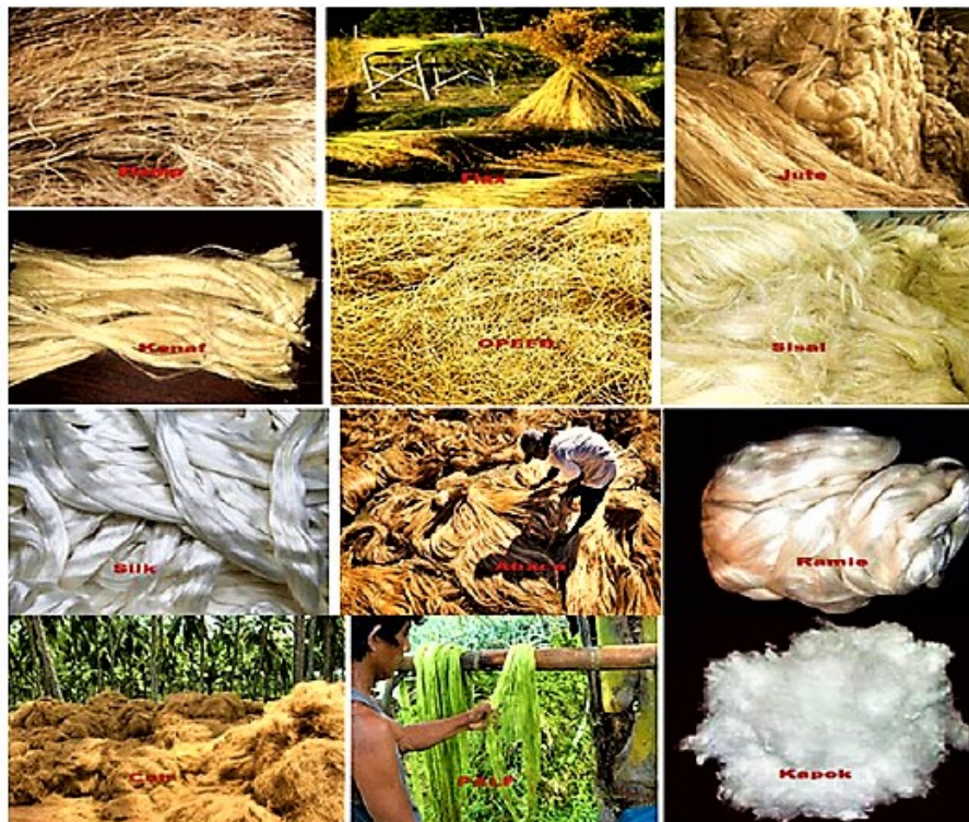
Figure I. 8. Différents types de fibres naturelles utilisées comme renfort [61].
