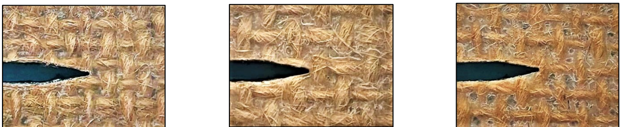
Figure IV. 15. Cas possibles d'emplacement du fond d'entaille dans les éprouvettes CT
