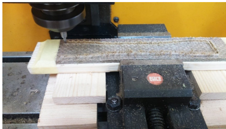
Figure III. 15. Usinage d'éprouvette par CNC.
