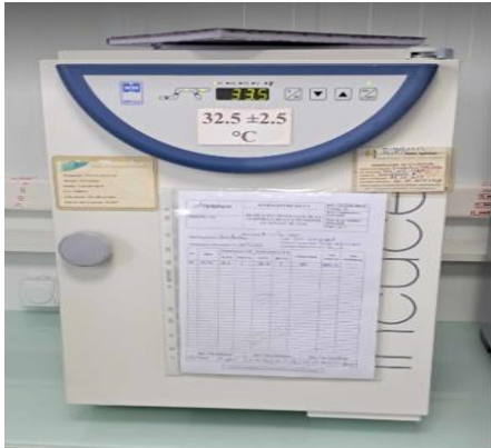
Figure I.16 : Incubateur 32.5 \pm 2,5 °C.
