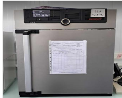
Figure I.17 : Incubateur 22.5 \pm 2,5 °C.
