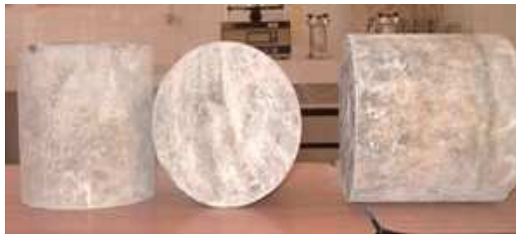
Figure III-1 : Eprouvette cylindrique 16×16 pour essai perméabilité
