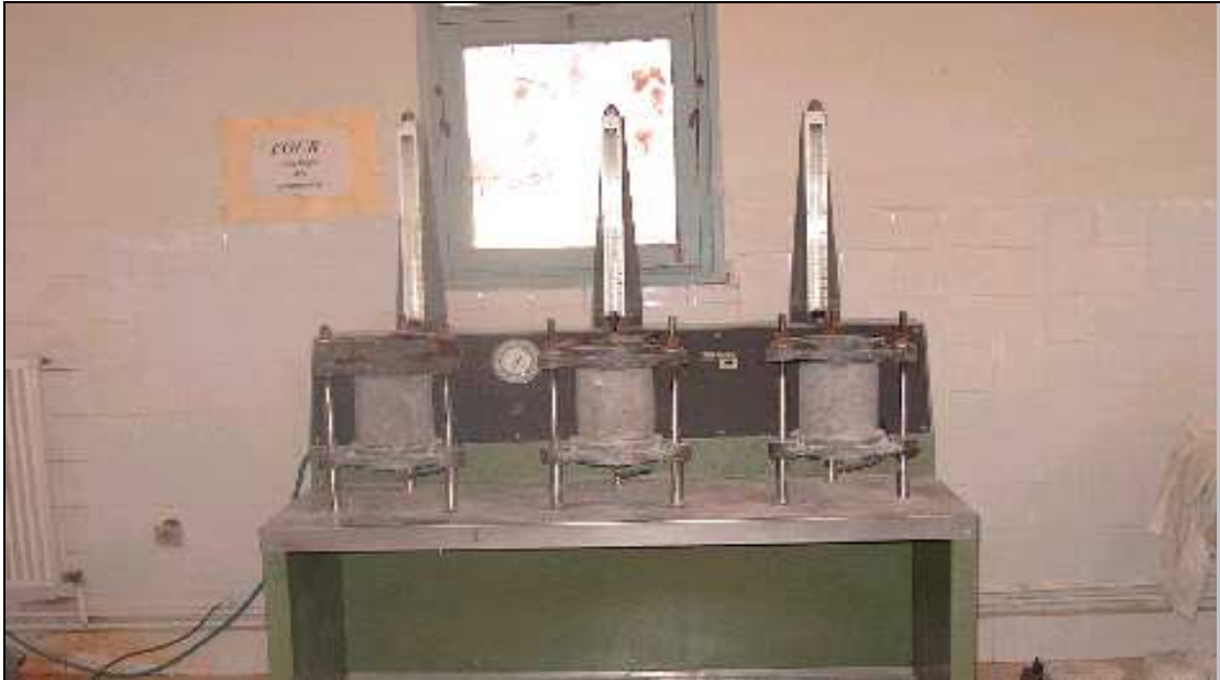
Figure III-2 : Perméamètre à l'eau ( laboratoire développement des Géomatériaux - M'sila )
