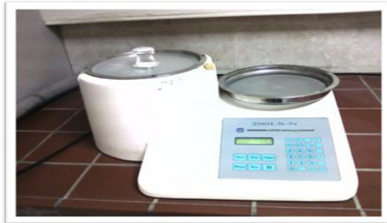
Figure.II-5: Tamiseuse alpine (laboratoire de Lafarge M'sila) alpine en service
