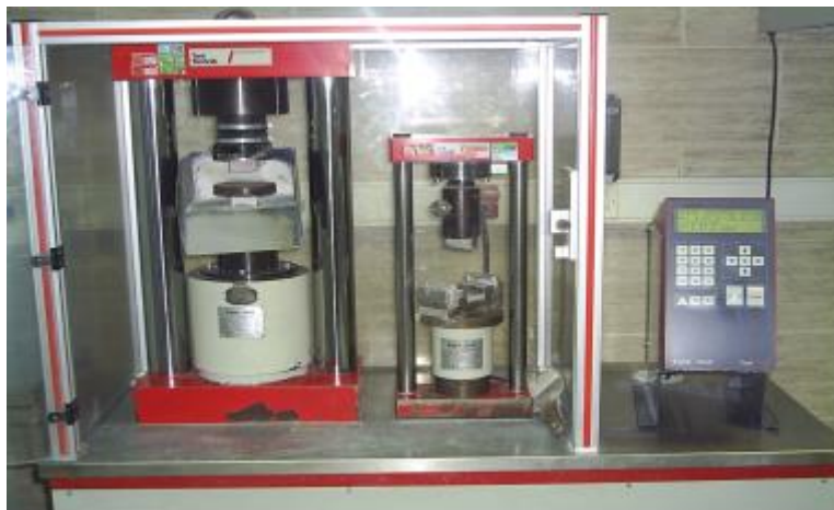
Figure.II-13 Machine de compression (Laboratoire de Lafarge M'sila)
