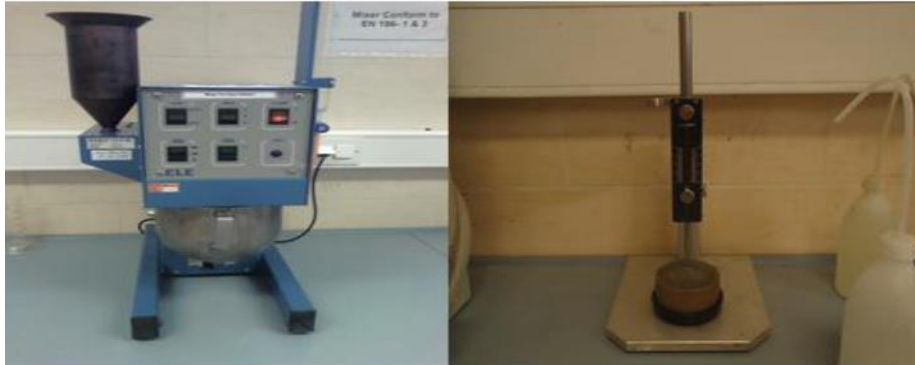
Figure.II-6 : Malaxeur et l'appareil de vicat.
