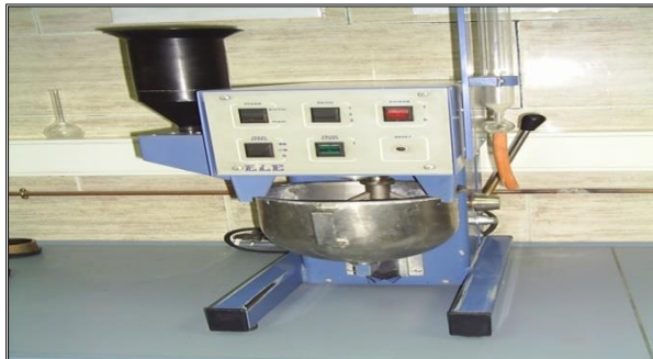
Figure II-10 Malaxeur semi-automatique de mortier Figure II-11 Eprouvette prismatique (4x4x16) cm 3
