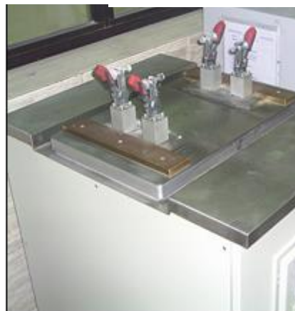
Figure II-12 Table à choc (Laboratoire de Lafarge M'sila)
