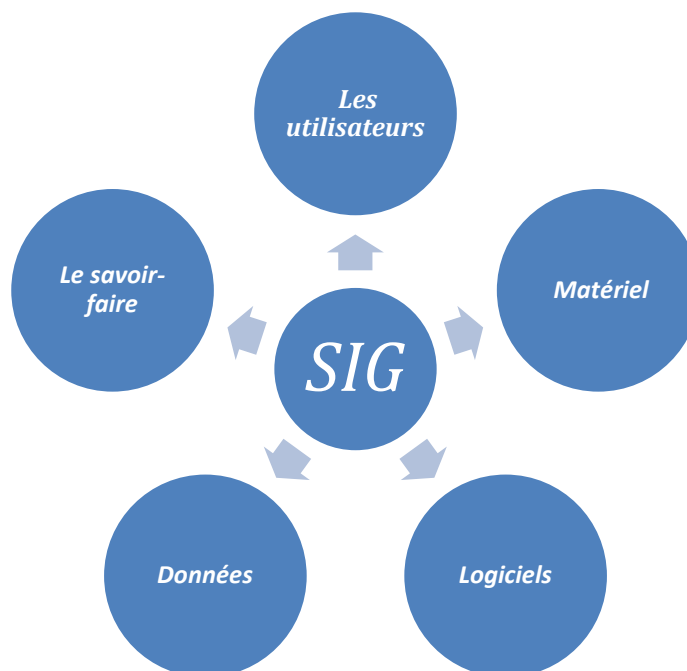
Fig. I.14. schéma des composantes d'un SIG.
