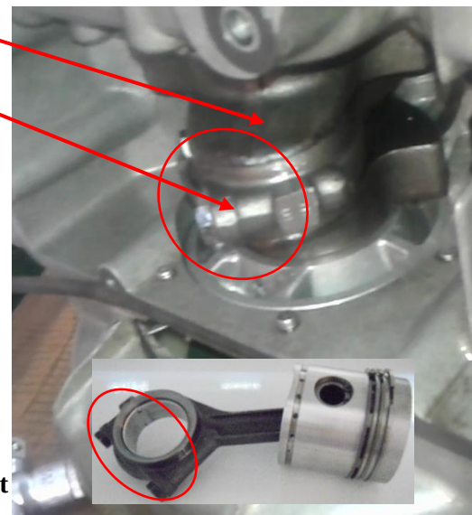
Figure II.16: Démontage de chapeau de bielle puis attelage
