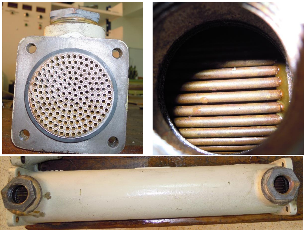
Figure II.53 : Echangeur eau/eau après nettoyage.
