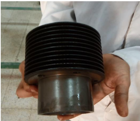
Figure II.11: Démontage de la chemise.
