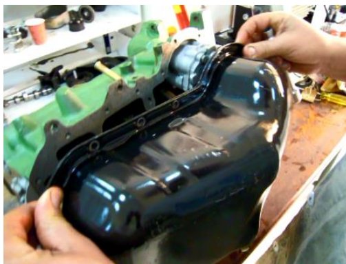
Figure II.56 : Remontage carter inférieur.
