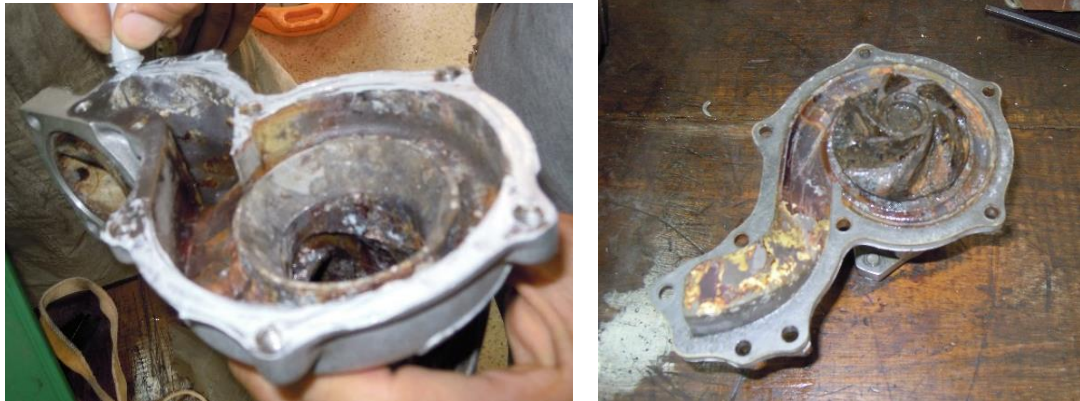
Figure II.50 : Pompe à eau après nettoyage et réparation.
