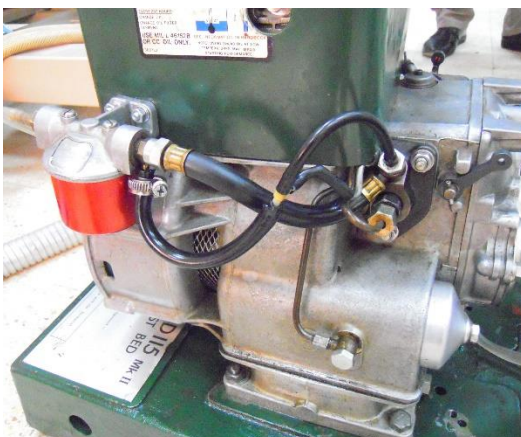
e) Bloc moteur (avant nettoyage)
