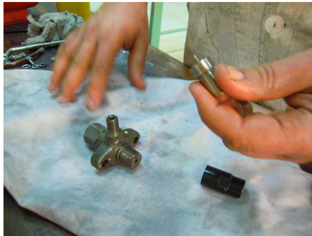
Figure II.31 : Démontage de l'injecteur.
