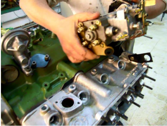
Figure II.62 : Remontage pompe à injection
