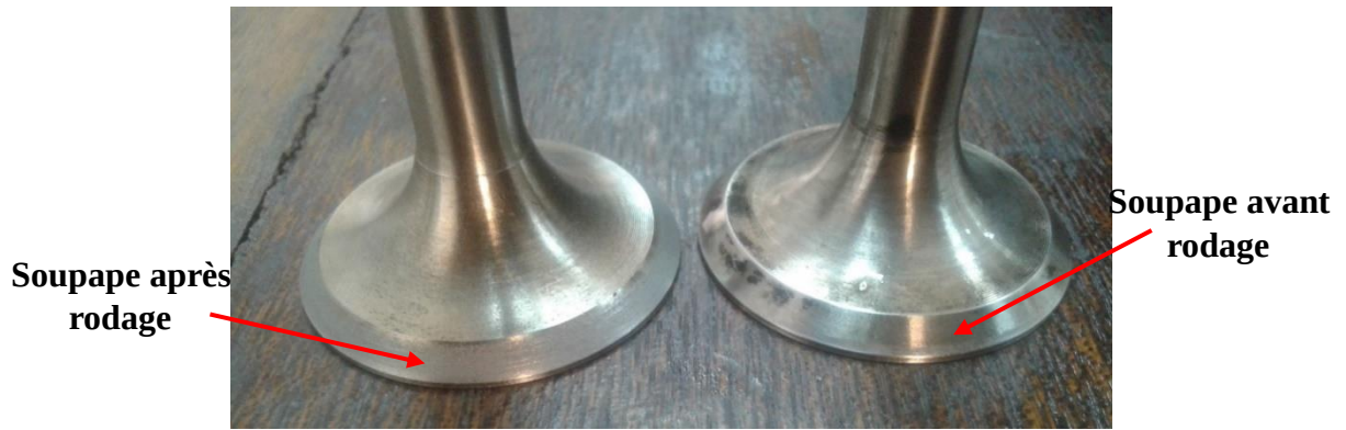
Figure II.26 : Soupape avant et après rodage.
