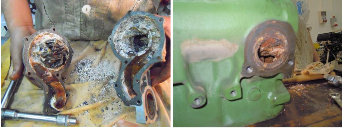
Figure II.49 : pompe à eau et circuit de refroidissement du bloc moteur avant nettoyage.
