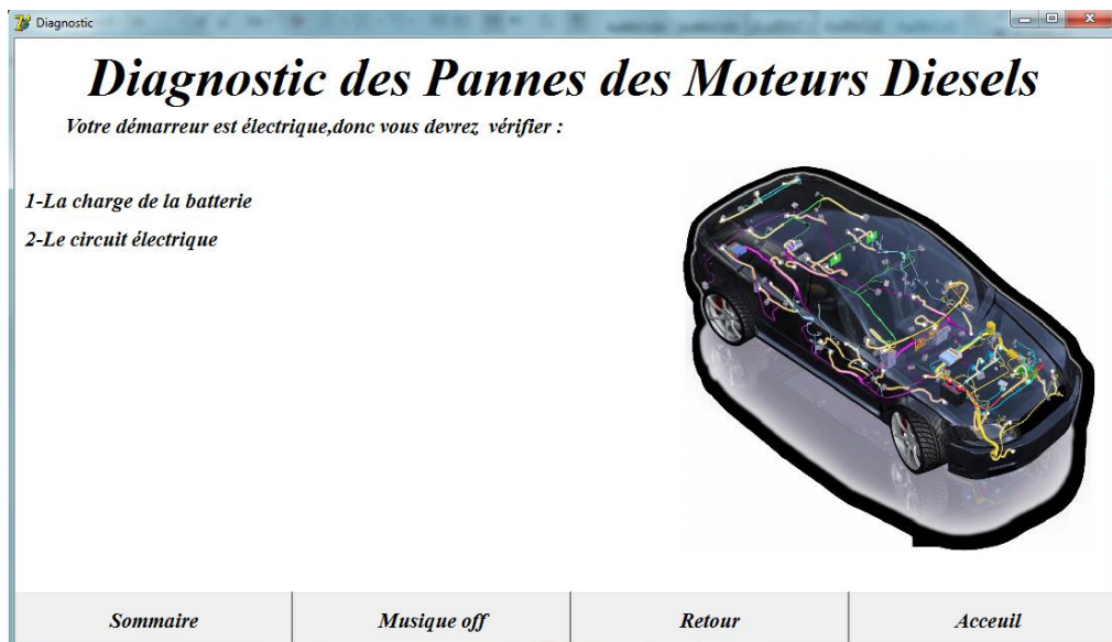
Figure III.9 : Causes probable des pannes de démarreur (DPMD 1.0).
