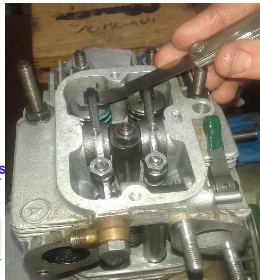
Figure I.44 : Réglage des jeux des soupapes moteur TD111 (Laboratoire moteur, université de M'Sila) [33].
