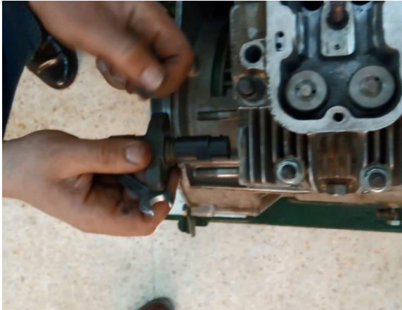
Figure II.7 : Démontage de l'injecteur.
