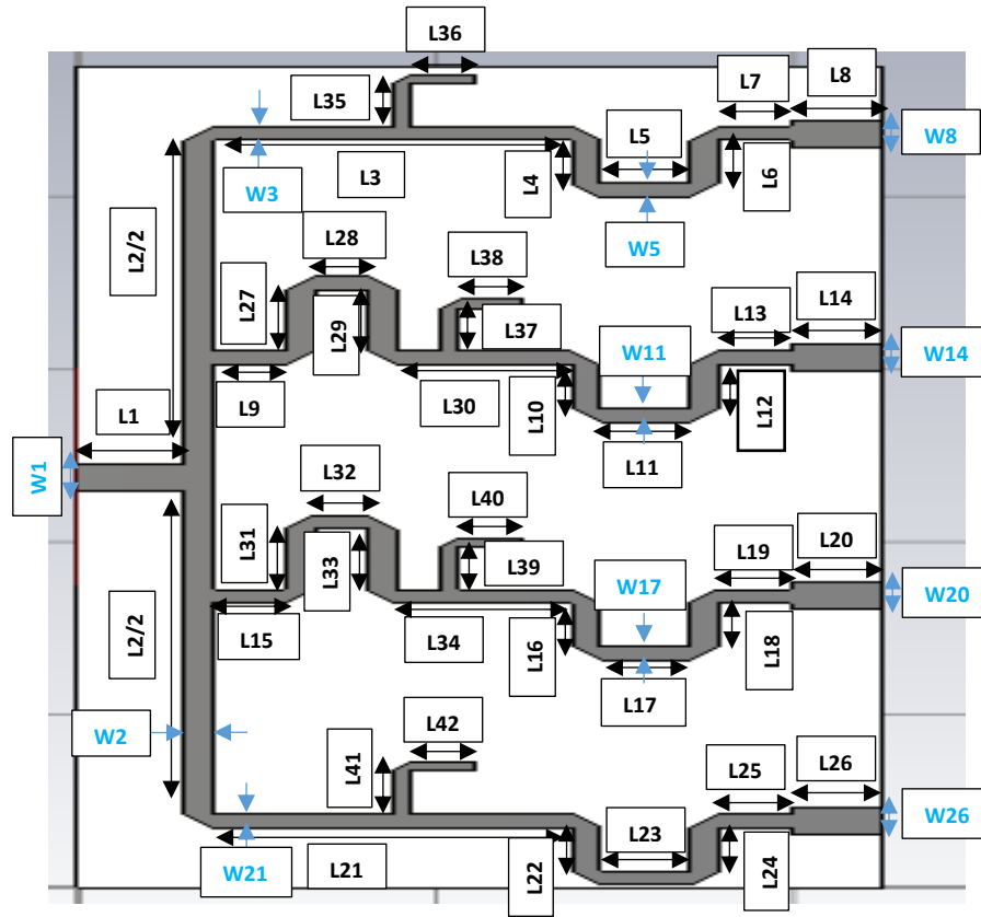
Figure IV.3 : Une forme proposée du diviseur de Wilkinson à quatre voies.
