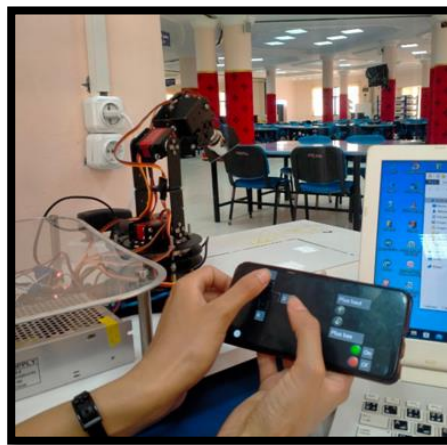
Figure III.14 : Déplacement du bras manipulateur.
