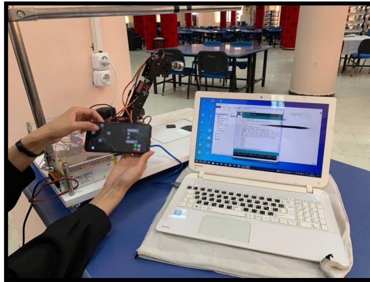
Figure III.11 : Notre bras manipulateur avec une commande Avancer pour obtenir la pièce.
