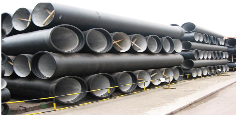
Fig.I.3. Canalisation en fonte ductile
