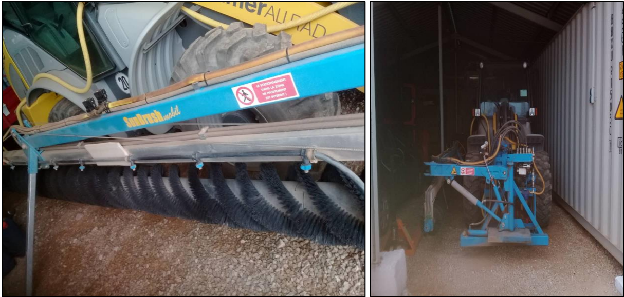
Figure II.10 : Machine mobile pour le nettoyage.
