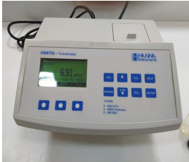
Figure. IV.3: Turbidimètre Hanna "HI88703"
