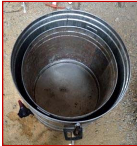
Figure II.2 : La chaudière à vapeur (©Florent Guillaud et Agnès Schryve)
