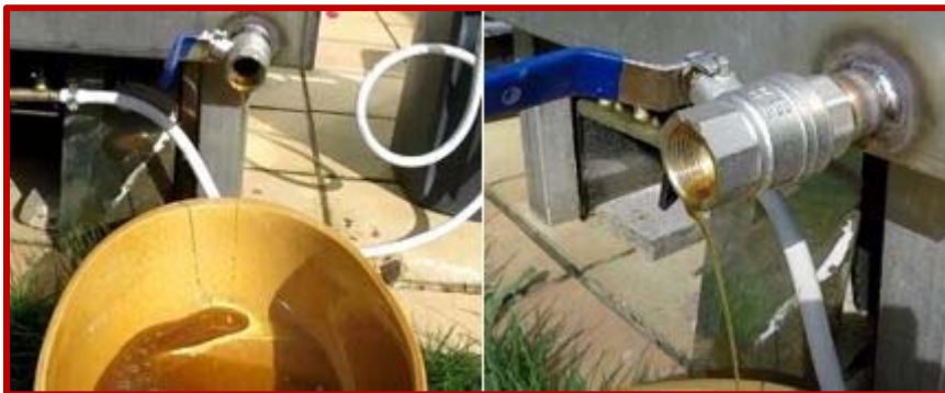
Figure III.6 : Sortie du liquide de cire fondu et filtré à travers le tube
