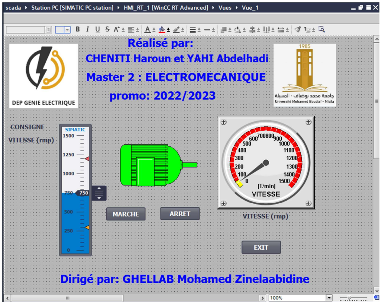
Figure III.14 : Supervision par WINCC Runtime
