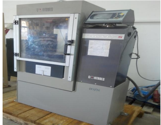
Photo VI.1. Appareil de la résistance à la compression
