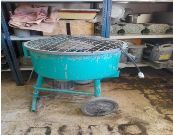
Photo III.1: malaxeur a béton
