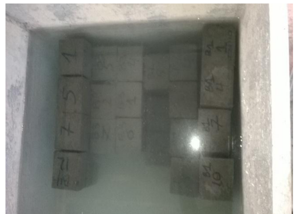
Photo VI.4: éprouvettes en eau
