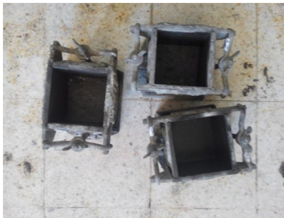
Photo III.2: moles du beton des éprouvettes (10x10x10 cm 3 )
