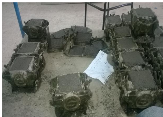
Photo VI.3: éprouvettes en 1j
