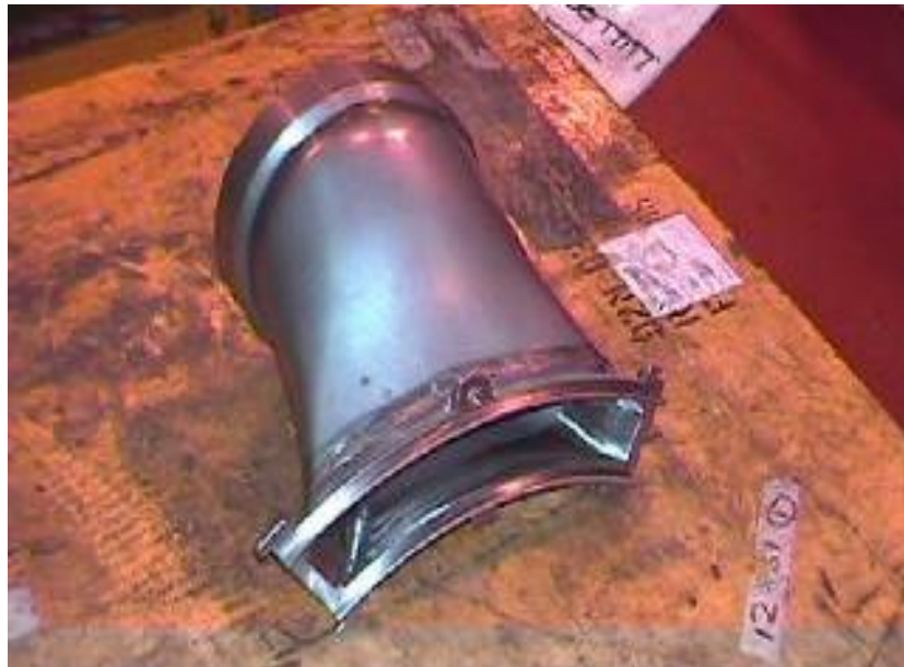
Figure 7. Raccord de transition BRITANNIQUE de Haynes 230 de puissance d'ALSTOM.
