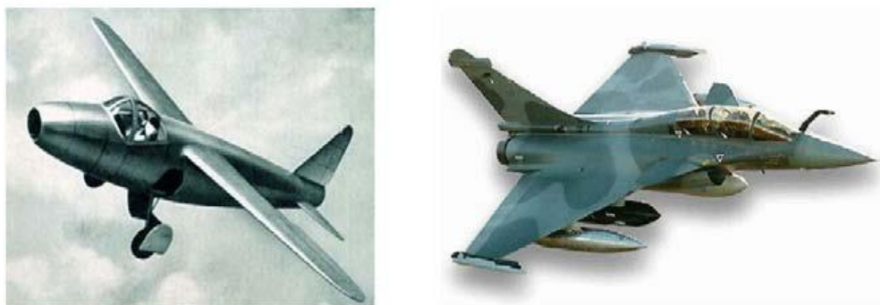
Figure 1 : A gauche, le premier avion à turboréacteur : le Heinkel He 178. A droite, soixante ans plus tard, le Rafale de Dassault Aviation, équipé du turboréacteur M88-2.
