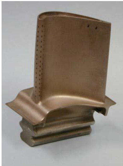
Figure 3 : Aube de turbine HP et ses trous de refroidissement.
