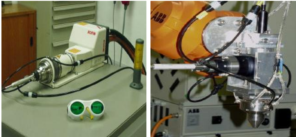
Figure 15. Équipement utilisé pour le métal de laser formant au centre de technologie de puissance d'ALSTOM : Un laser de diode couplé par fibre de puissance élevée (laissé) fournit plus W de 1000 de puissance de laser à un bec coaxial de poudre qui (droit) est manœuvre par un robot de 6 axes.
