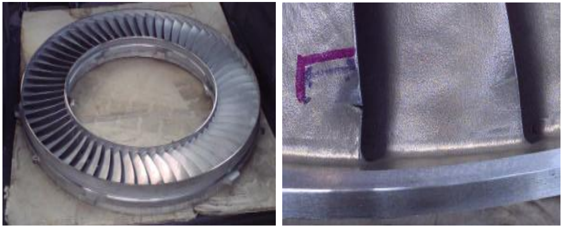
Figure 9. Investissement a moulé le rebord arrière palette endommagée/défectueuse de montra d'anneau de segment du redresseur U500.
