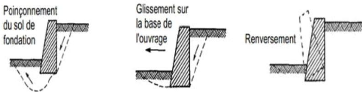
Figure I.10: Trois type de stabilité externe
