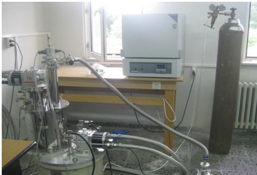
Figure 2.11 : Le système OXFORD, Edwards Model CS2/9 cryogenic.
