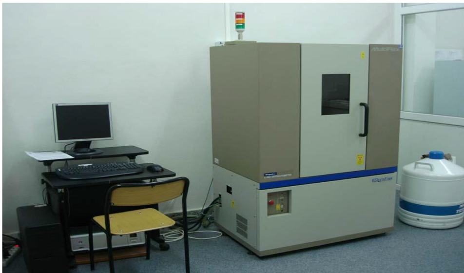
Figure 2.8 : Diffractomètre Rigaku MultiFlex 2kW, université Abant İzzet Baysal - Bolu - Turquie.
