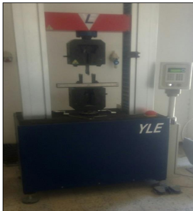
Fig. (II.5) : la machine de l'essai de traction
