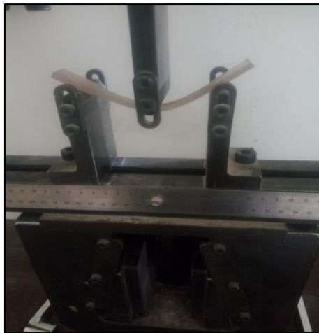
Fig. (II.4) : Test de flexion trois point
