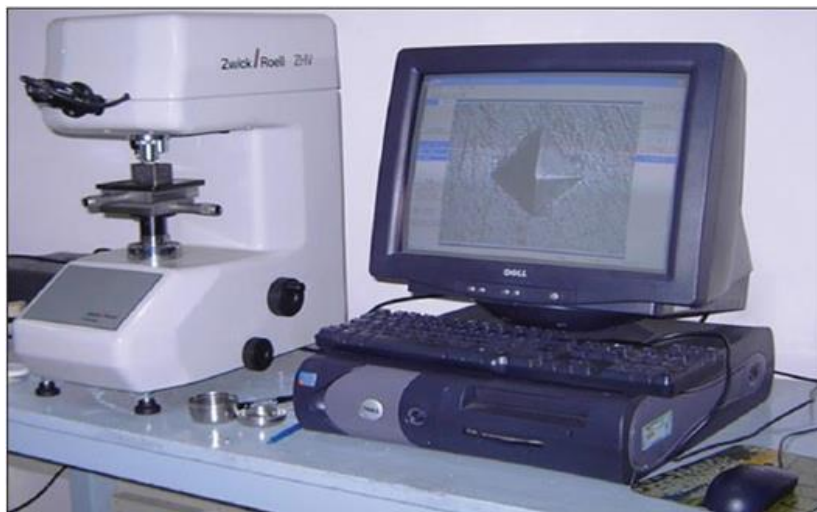
Fig. (II.7) : Machines de dureté Vickers
