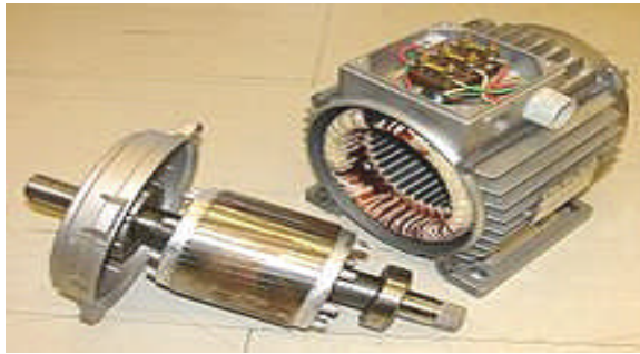
Figure 1.1 Rotor (à gauche) et stator (à droite) d'une machine asynchrone.
